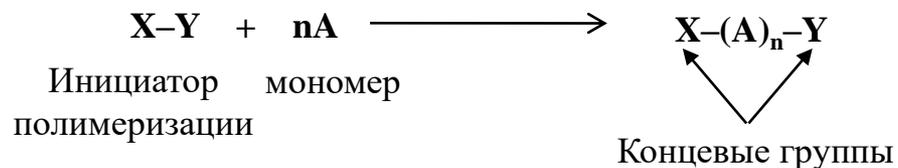
Реакция полимеризации может протекать по **ионному** или **радикальному** механизму. Ионная полимеризация подразделяется на катионную (промежуточные частицы – катионы) и анионную (промежуточные частицы – анионы).
