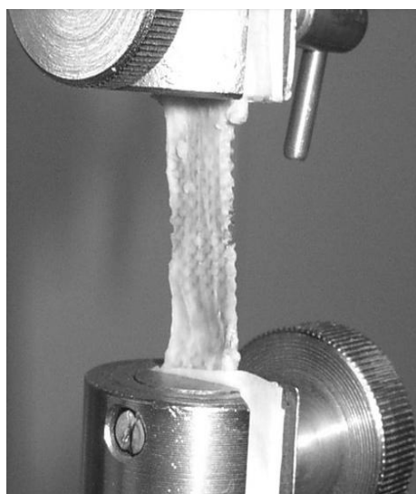
Рисунок 17 – TVT при нагрузке 16 Н через 30 суток пребывания в тканях
