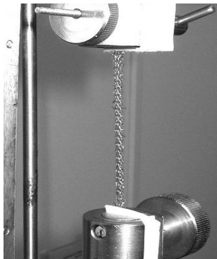
Рисунок 16 – TVT при нагрузке 16 Н до имплантации
